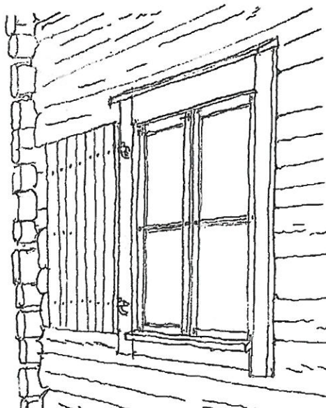
FÖNSTER MED "VATTBRÄDA" ÖVER OCH UNDER.
